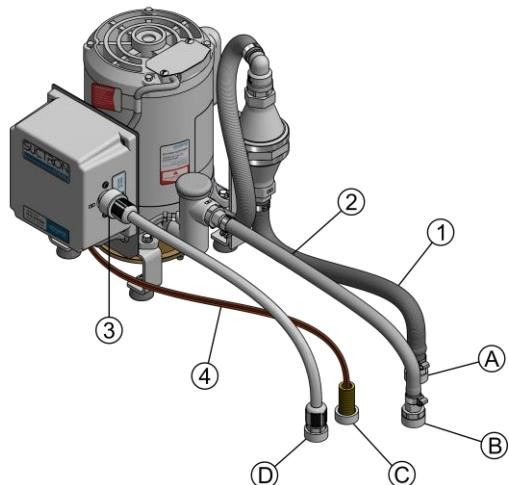
Rosquear a entrada de água de 1/2" na esperada (ponto "D"- Água) rente ao piso e a de 3/4" na conexão de "Entrada Água" (Nº 3) na SUCTRON.
