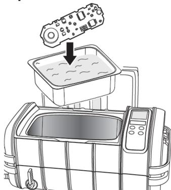
Objetos são colocados em recipientes separados. As ondas de ultrassom penetram no recipiente para realizar a limpeza.
